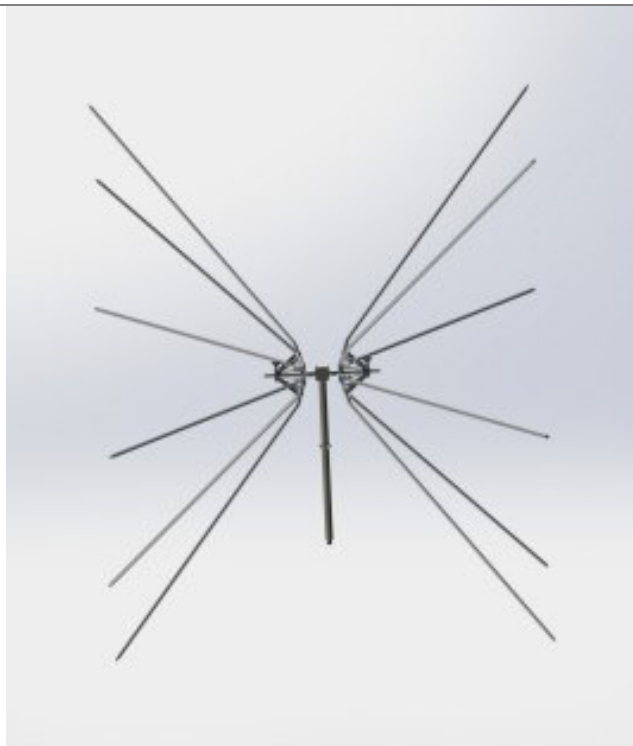
Abb. 3: Balun + BBFA 9146 Elemente mit großem Öffnungswinkel und ohne Extensions.
